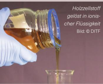
Holz Zellstoff gelöst in ionischer Flüssigkeit
