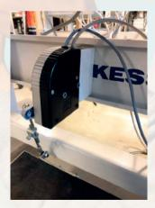
Beim Retrofitting von Nähmaschinen können über das Pedal verschiedene Daten zur späteren Analyse ermittelt werden.
