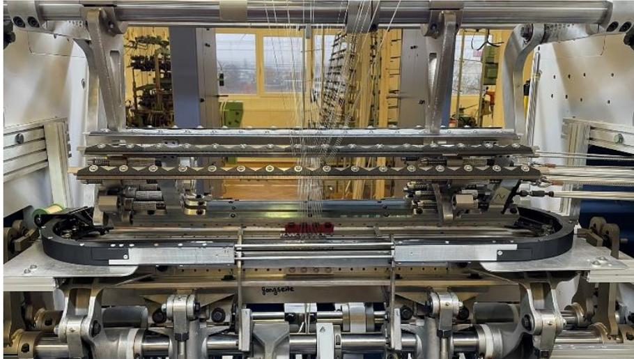
*Abbildung 2: Neu entwickeltes umlaufendes Schusseintragsystem eingebaut in einer handelsüblichen Doppelraschelmaschine (ITM))*
