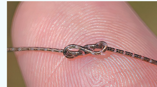
In einer einzigen Faser von nur 50 Mikrometer Dicke, können Stromversorgung, Sensorik, Anzeige und Signalverarbeitung ohne externe starre Komponenten integriert werden.
