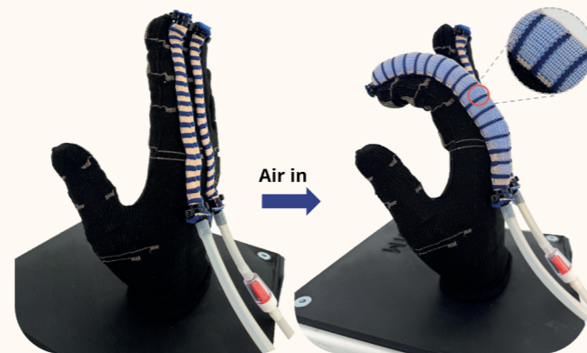
Portable gestrickte Orthese zur Unterstützung der Fingerbeugung.
