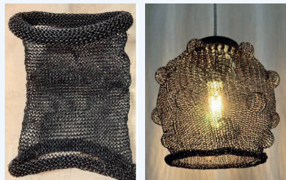
Gestrickte Wuchshülle und ein Lampenschirm aus Lignin ummanteltem Garn. Bild DITF
