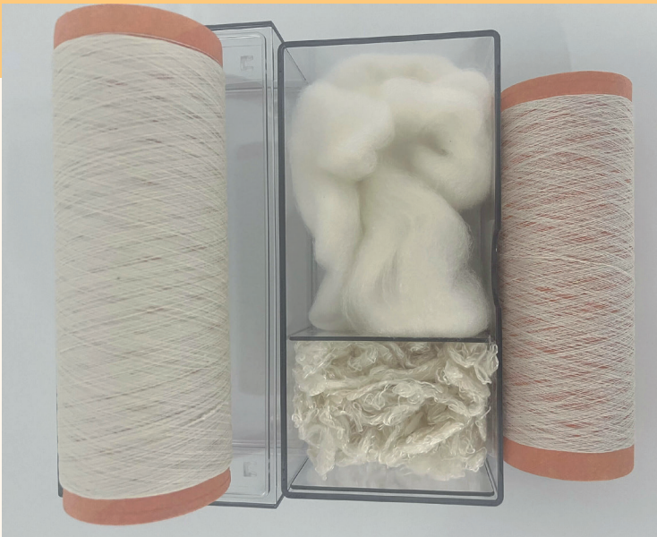
An den DITF gesponnene Filamentgarne nach dem HighPerCell®-Verfahren. Bild: © DITF
