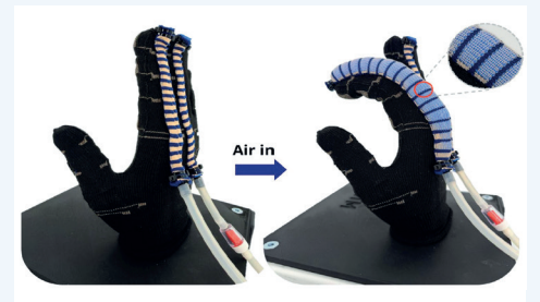
Pneumatischer, gestrickter Handschuh. Bild ITM
