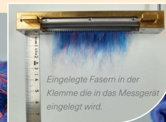
Eingelegte Fasern in der Klemme die in das Messgerät eingelegt wird.
