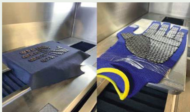
Bedruckte Textilien mit einer Lignin-Beschichtung für die Verwendung in Handschuhen, Fotos: DITF
