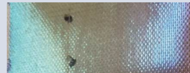
Unterschiedliche Färbung am linken und rechten Rand einer Probe mit ITO-Beschichtung. Bild: © Philipps-Universität Marburg
