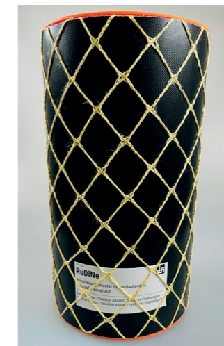
Aramidnetz mit gestrecktem Schussfaden. In die neuen rundgewirkten und knotenlosen Netzstrukturen können Sensoren integriert werden, die Materialverschleiß rechtzeitig erkennen. Die Innovation ist aber auch geeignet, um materialsparender zu produzieren. Bild ©: STFI
