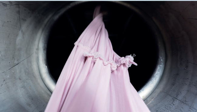
Offen, breit, offen, breit – bis ein Gestrick die Ausrüstung verlässt, wird es mehrfach zusammengeknüpft und wieder aufgetrennt, um die Prozessschritte optimal zu durchlaufen. Bild: © Textilveredlung Keller
