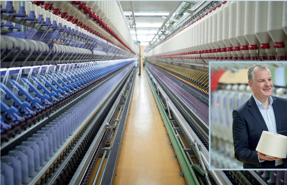
Rund 70 Meter lang sind die Ringspinnmaschinen, auf denen aus der spanischen Baumwolle ein fein gesponnenes Garn wird. Bild: © Gebr. Otto
